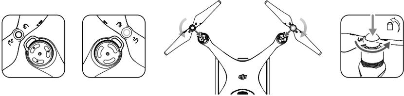
**⚠** Перед каждым полетом проверяйте надежность крепления пропеллеров.
